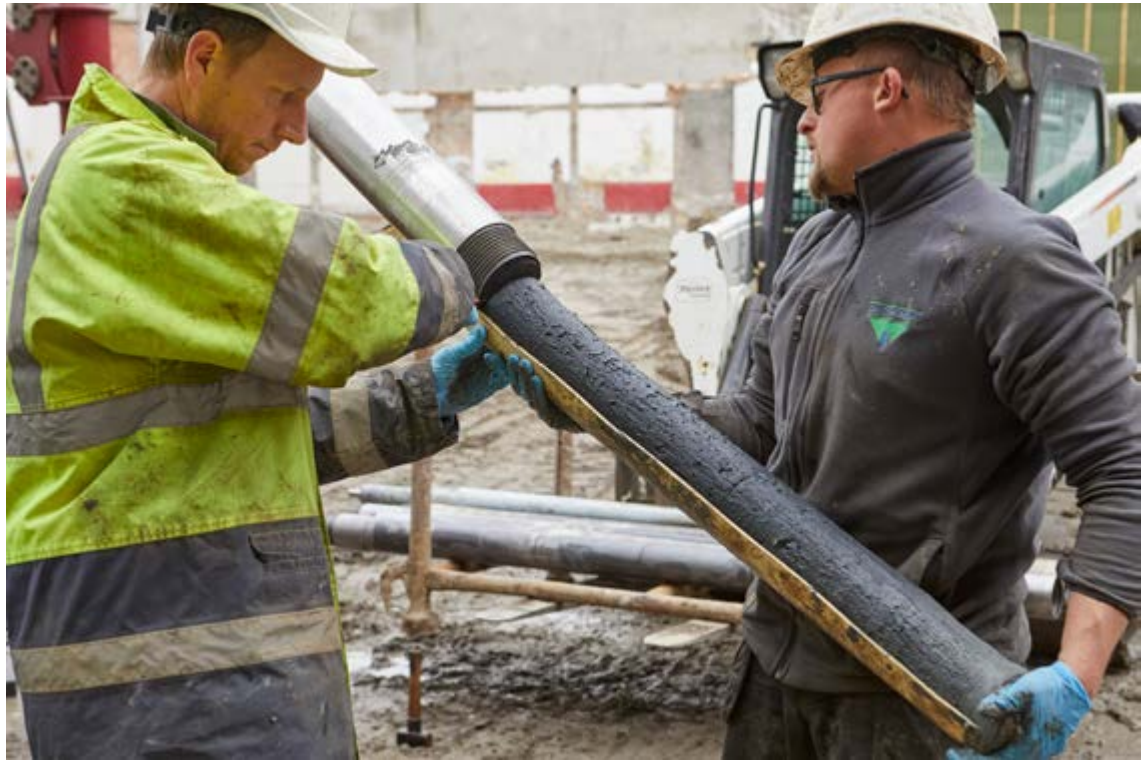
Fig. 2: De Aqualock 100 mm levert ongestoorde bodemstalen die naderhand voor verder onderzoek beschikbaar zijn (© agentschap Onroerend Erfgoed, foto: Kris Vandevorst).
