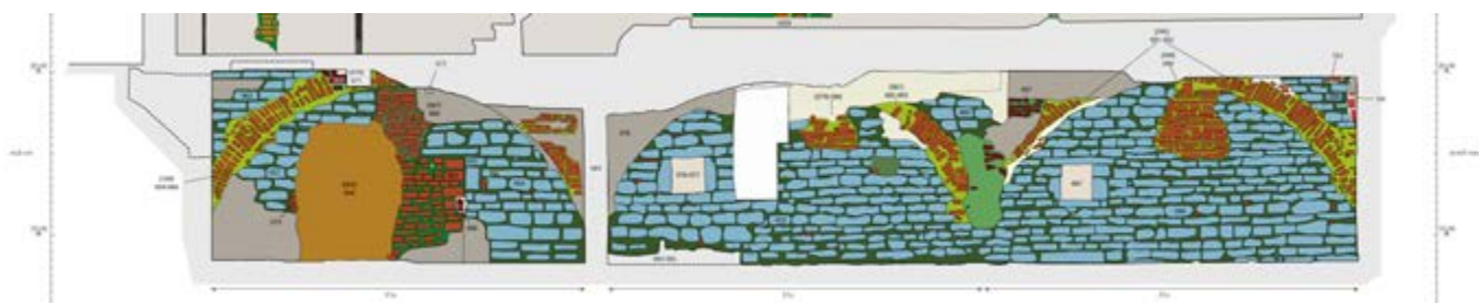
Fig. 1: Relevé pierre à pierre du mur sud de la cave de la maison rue de la Tête d'Or 9-11 © urban.brussels- ULB ; DAO ULB.
