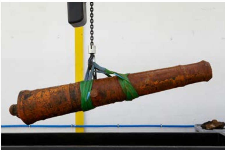
Fig. 1: Het kanon gevonden op het strand van Oostende-Oosteroever tijdens de conservatiebehandeling. Om dit soort grote en zware ijzeren objecten te behandelen zijn grote bakken gevuld met vloeistof en krachtige hijstuigen nodig © Agentschap Onroerend Erfgoed, foto: Sven Van Haelst.
