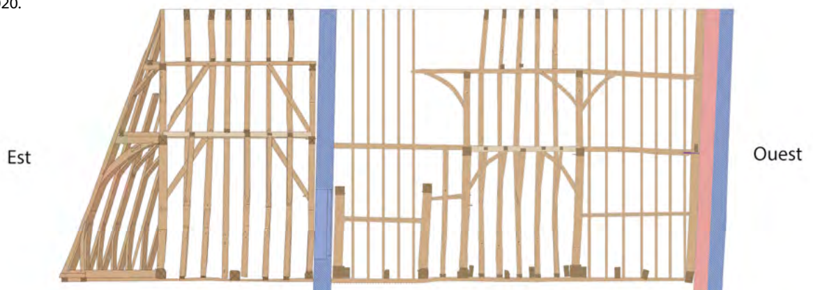
Fig. 2 Relevé archéologique de la charpente de la chapelle de Marie-la-Misérable, ©MRAH-IRPA-urban.brussels, 2020.
