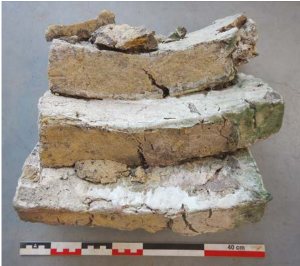
Fig. 2 Samengeklitte bakstenen met duidelijke sporen van verglazing op de opgraving Brugge de Spie.
