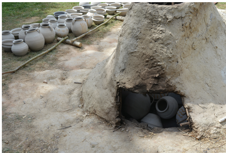
Fig. 2. Chargement des récipients à cuire dans le four reconstitué à Barsy en juillet 2019.
