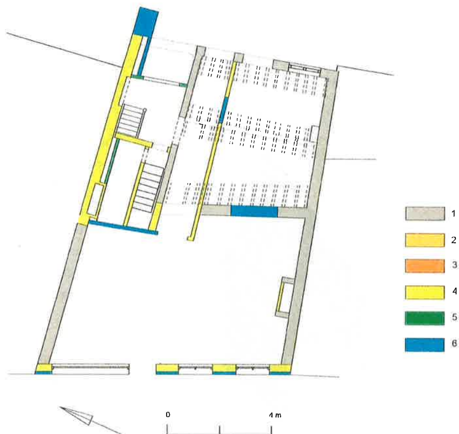
Fig. 2: Veurne, Noordstraat 25. Grondplan van de gelijkvloerse verdieping. 1: 1616-1622, 2: 1627, 3:15de-16de eeuw, 4: kort voor 1859, 5: aanpassingen na 1902, 6: 1968-1971
