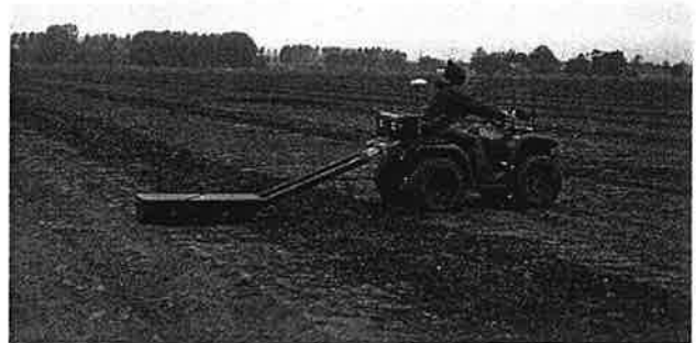
Fig. 2. Sensor in een slee, getrokken door een quad met veldcomputer en GPS
